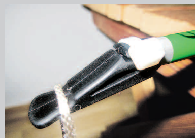
Neuer Clip ohne Sicherung mit 8 kg Belastung
