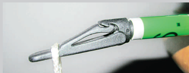
Neuer Clip ohne Sicherung mit 8 kg Belastung
