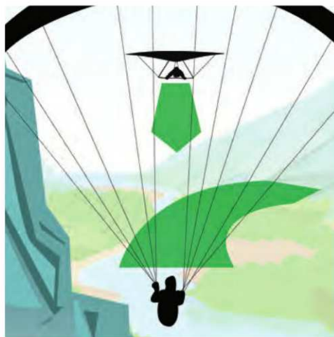
Soaren am Hang: Das Fluggerät mit dem Hang an der linken Seite weicht nach rechts aus.
