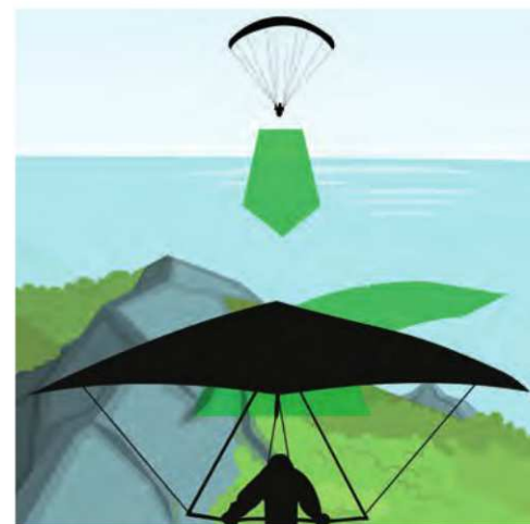
Soaren oberhalb des Hangs: Das Fluggerät mit dem Lee an der linken Seite weicht nach rechts aus.
